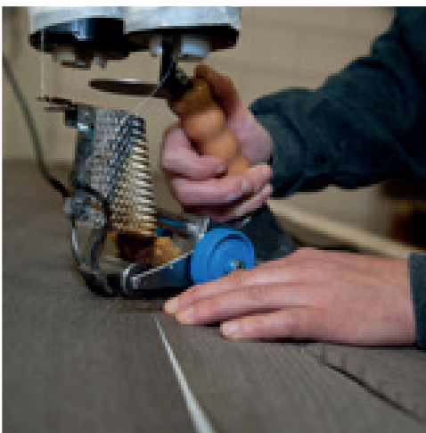
Het handmatig samenstellen van stroken voor het verlijmen. Das Zusammensetzen der einzelnen Furnierstreifen erfolgt in aufwendiger Handarbeit.
